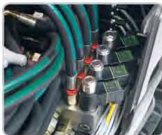
Připojit/odpojit bez nástrojů.
