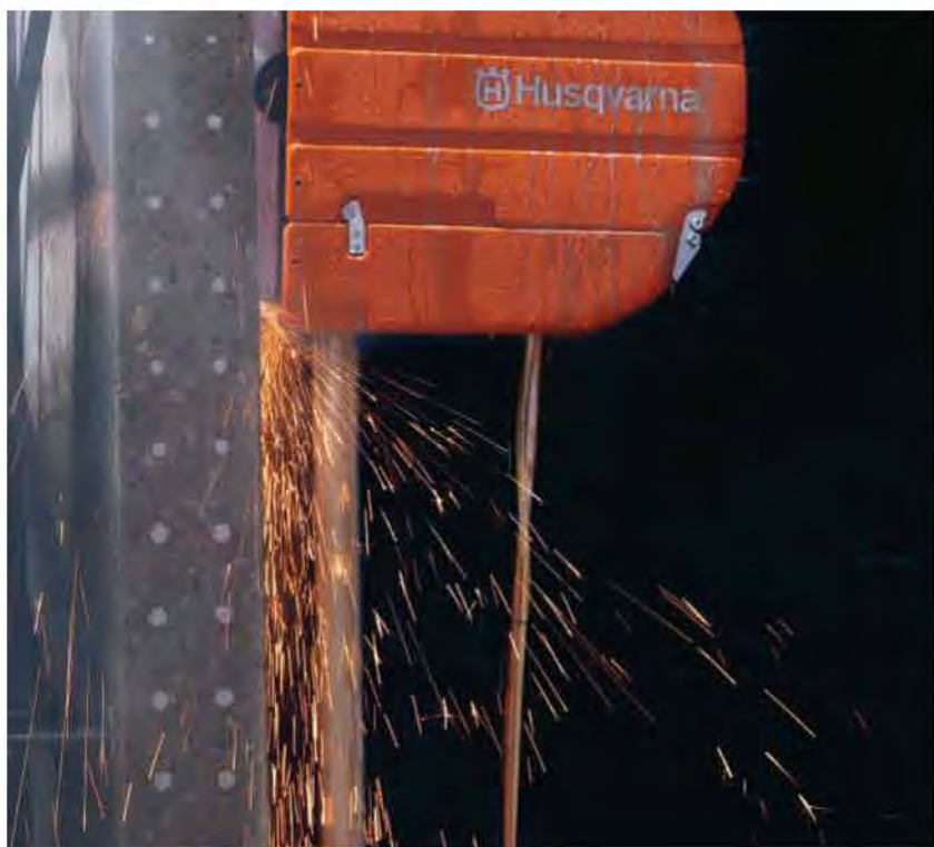
Tento obrázek ukazuje, jak efektivně kotouč Diagrip™ řeže do vyztuže.
