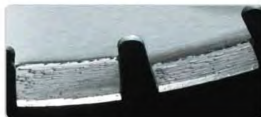
Kotouče F685 mají zapuštěné nebo snížené segmenty jako ochranu proti podřezu a opotřebení ocelového těla kotouče.
