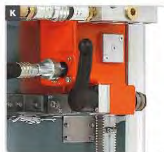
Držadlo pro posuv pro nastavení hloubky.
