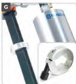
Dorazový kroužek pro měření hloubky otvoru.
