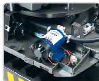
Elektrické plnicí čerpadlo.
