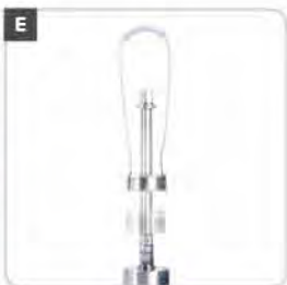
Přípravek k vyjmutí vrtáku z otvoru.
