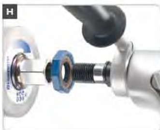
Rychlouvolňovací matice pro uvolnění vrtáku z vrtáčky.
