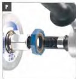
Rychlounvolňovací matice pro uvolnění jádrového vrtáku z vrtáčky.
