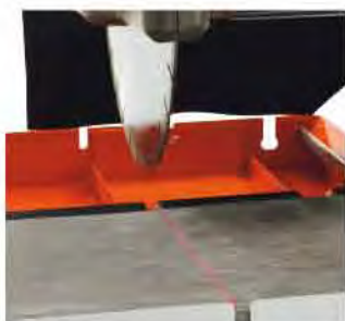
Laserové ukazovátko umožňuje rychlé nastavení správné polohy materiálu pro řez.
