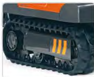
Na přání hydraulické napínání pásu.
