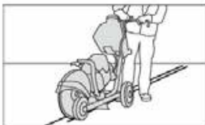
Řezání na vodorovných plochách (drážky).
