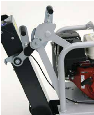
Zentrale Rotor-Schnellabsenkung/ -Aushebung
