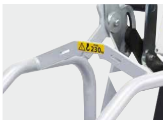
Zentraler Kranhaken und Rammschutz = erhöhte Betriebssicherheit = einfacher Transport
