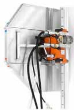
Husqvarna WS 325 má hloubku řezu 400 mm.
