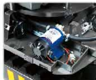
Elektrické plnicí čerpadlo.
