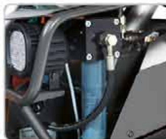
Mazací čerpadlo a systém automatického mazání pro nástroje jako standard.
