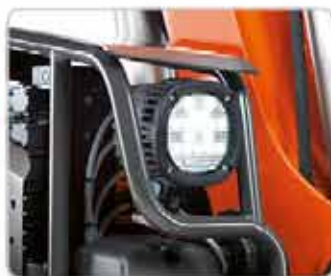
Extravýkonné LED svítidlo odolné proti vibracím.
