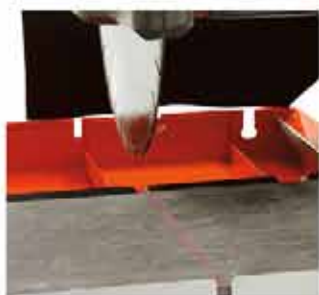
Laserové ukazovátko umožňuje rychlé nastavení správné polohy materiálu pro řez.
