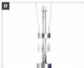
Přípravek, usnadňující vyjmutí vrtáku z otvoru.
