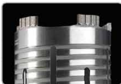
Válec s odvodem, se speciálními drážkami mezi segmenty a větší šířka segmentů umožňuje efektivní odstraňování prachu.
