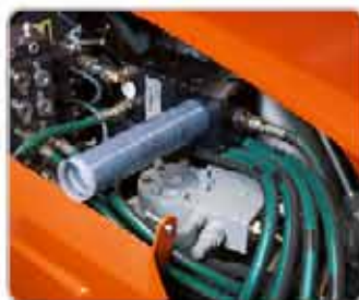
Mazací čerpadlo a systém automatického mazání pro nástroje jako standard.
