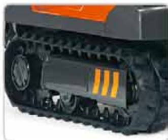
Standardně hydraulické napínání pásu.
