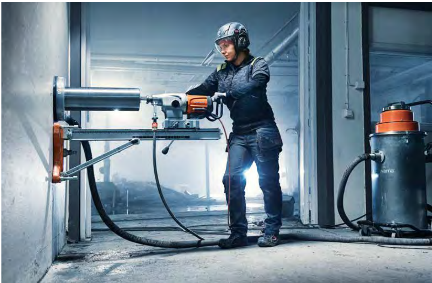
15 Automatický vrtací systém AD 10
