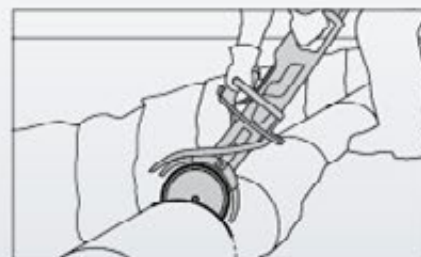
Hluboké řezání v rýhách pro potrubí.
