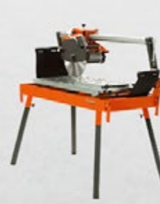
HUSQVARNA TS 100 R 2200/2700 W, max Ø 350 mm, max řezací hloubka 105 mm, 106 kg.
