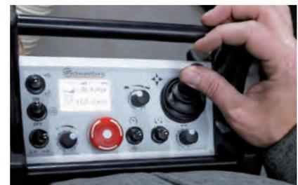
Fernbedienung zur Steuerung des Schleif- und Fahrbetriebs
